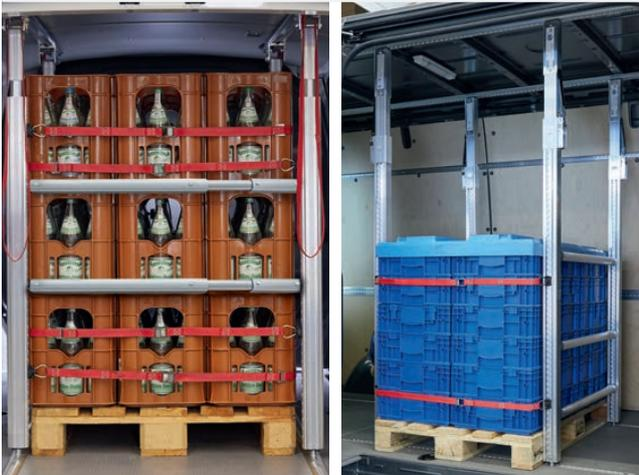
Le rail de pavillon est fixé sur les traverses transversales du toit. Ceci doit être relié avec des éléments appropriés à la face avant et aux portes arrière. De cette manière, les efforts liés à la charge seront renvoyés de manière uniforme sur la structure rigide du véhicule.
