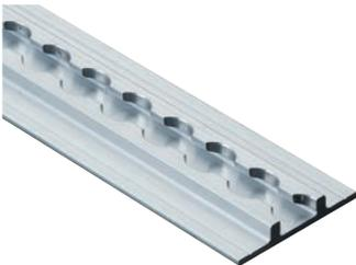
Les rails de sol sont fixés idéalement par collage et vissage dans la carrosserie du véhicule. Ainsi, la capacité de charge est renvoyée dans la structure rigide du véhicule. Afin d'obtenir une profondeur optimale des filets, il est nécessaire d'installer les rails du TransSAFE<sup>®</sup>rack avec un écartement de 615 mm.
